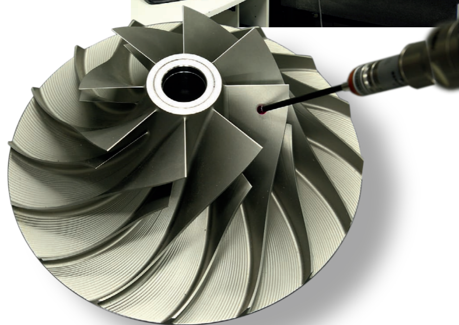
Le giranti oggetto della lavorazione variavano da un diametro di 100 mm fino ad un massimo di 350 mm; il materiale impiegato per la loro realizzazione è stato l'alluminio, il titanio e l'acciaio inox AISI 630 (17-4-PH)
